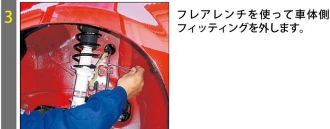
フレアレンチを使って車体側フィッティングを外します。
