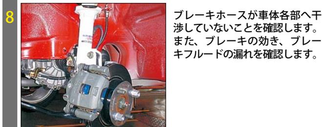
ブレーキホースが車体各部へ干渉していないことを確認します。また、ブレーキの効き、ブレーキフルードの漏れを確認します。
