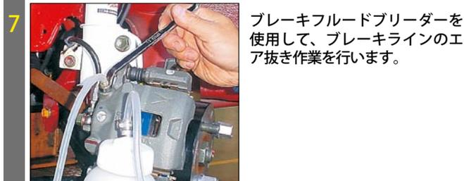
ブレーキフルードブリーダーを使用して、ブレーキラインのエア抜き作業を行います。
