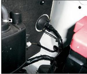
**7** バルクヘッドにある、配線用ブーツに切り込みを入れて、センサーハーネスを車内に引き込みます。
