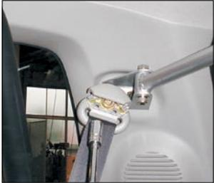
シートベルトアンカーを左右ベースに取り付けます。
