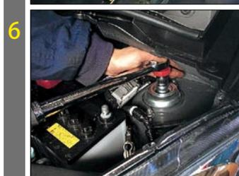
ストラット下側同様に、アッパーマウントを増し締めし、トップナットを必ず指定のトルクで締付けます。
