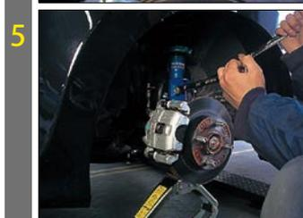
ジャッキ等でナックルの位置を上げ、接地時に近い状態にし、ストラット下側を増し締めします。
