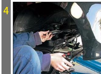
純正のスプリング、スプリングアッパーシートを取外します。
