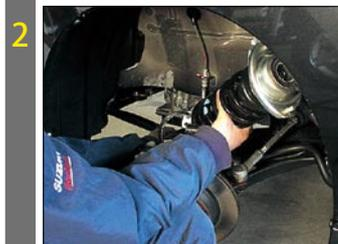
純正のストラット ASSY を取外します。
