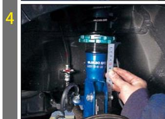
基準皿位置にロックシートを調整し、ロアシート、ロックシートを車高調整レンチにて締付けます。
