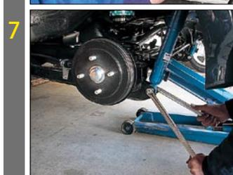
まず、リヤショックアブソーバの上側を固定します。その後スプリングを装着し、リヤショックアブソーバの下側を固定します。ハイトセンサーも元の状態に戻します。フロント同様、アクスルを持ち上げ、接地時に近い状態にし、増し締めします。
