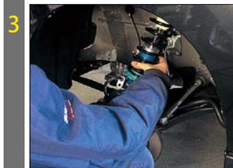
スポーツコンフォート車高調整サスペンションの、ストラット ASSY を車体に取付けます。
