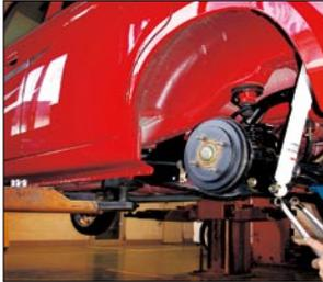
6 各部のボルトナットを締め付けます。
