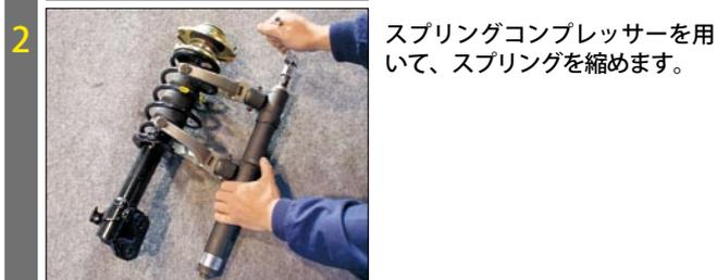
スプリングコンプレッサーを用いて、スプリングを縮めます。
