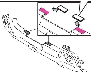
5 ガード, フロントアンダスプラッシュにナンバープレート取付け穴(Φ6.5)を開けてください。
