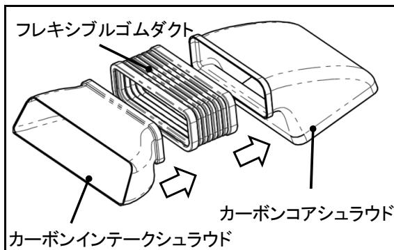
3-3 ・インタークーラーコアにカーボンコアシュラウドをはめ、横から左右2箇所ずつ、外した樹脂クリップを使用し、取付けてください。
