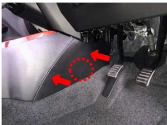
運転席側の左足元にあるコンソールカバーを上後方へ持ち上げ、コンソールカバーからクリップを外します。
