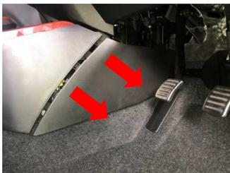
コンソールカバーを下前方へスライドさせてコンソールカバーを取外します。
