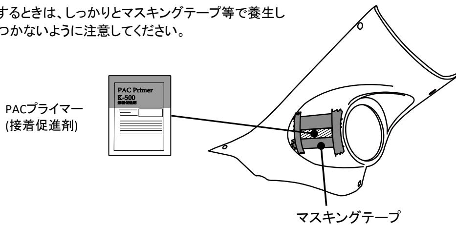
7、両面テープの剥離紙を剥がし、穴位置に注意しピラーカバーに貼付け、圧着してください。
