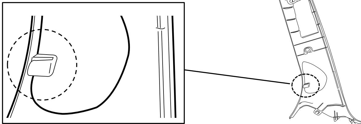
3、一度ピラーカバーを取り付け、②両面テープの剥離紙を剥がさずにマーターフードを仮合わせし、穴位置(4ヶ所)に墨書きを入れてください。
