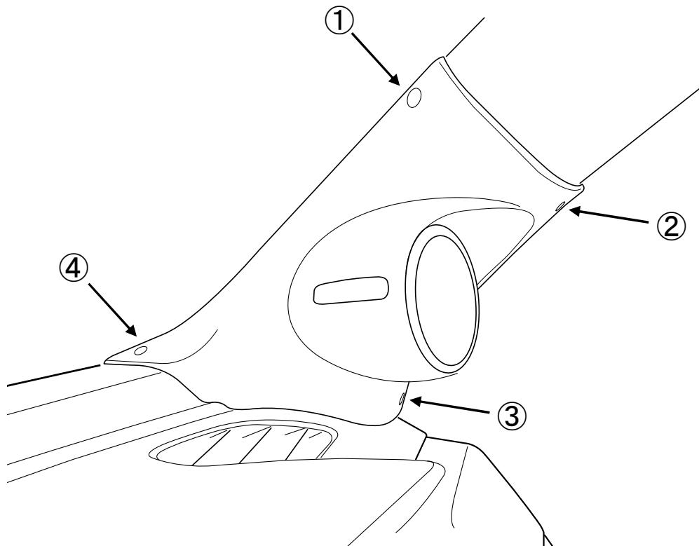
5、再度ピラーカバーを車両より取外し、墨書きを入れた位置に $\phi 1\text{mm}$ のドリルで穴あけ作業を行ってください。
