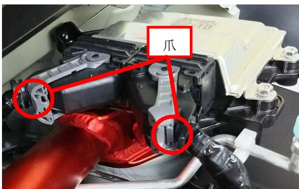
1-3 手前 2 個のボルトを外し、手前に引き車両から ECU を取り外します。
