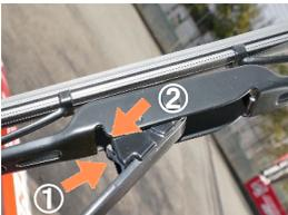
ワイパーブレードを傾け、根本のツメを押込み(①)、スライド(②)させてブレードを取外します。
