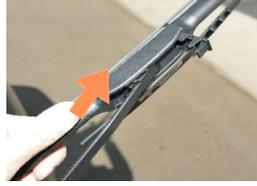
アームのU字クリップ部にブレードを取付け、ブレードを矢印の方向へ[カチッ]と音がするまでスライドさせて固定します
