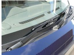
同じ手順でもう一方のブレードも交換します。
