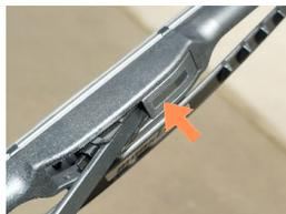
ブレードがアームに確実に固定されているか確認を行い、カバーを下げてください。
