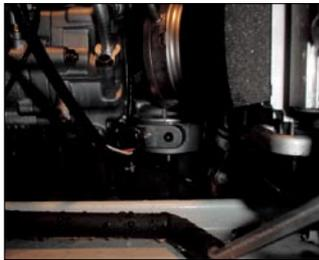
センサーハーネスの根元を極力曲げないように、タイラップなどでハーネスを固定します。
