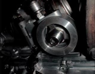
車体へセンサーを取付けたアタッチメントと、オイルフィルターを取付けます。
